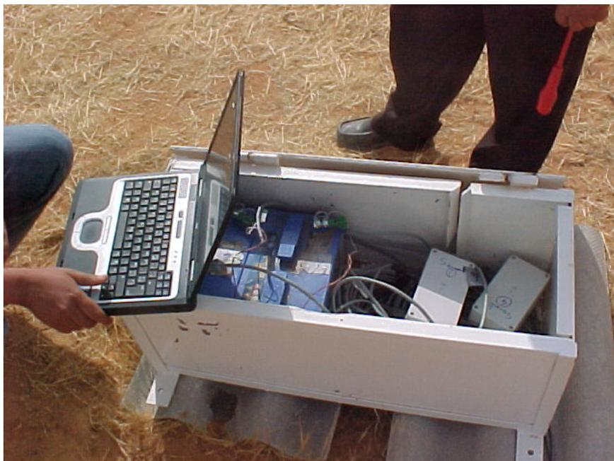
Figure 6 : Boîtier d'acquisition des données de Sensit©
