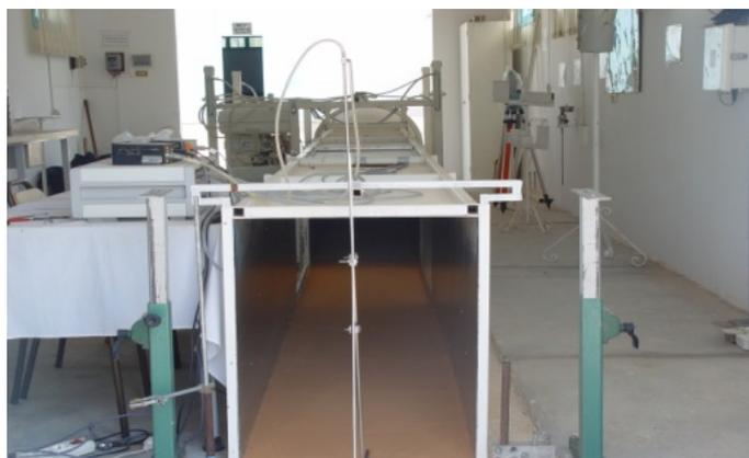
Figure 3 : Instruments de mesure installés à la section de sortie du tunnel
