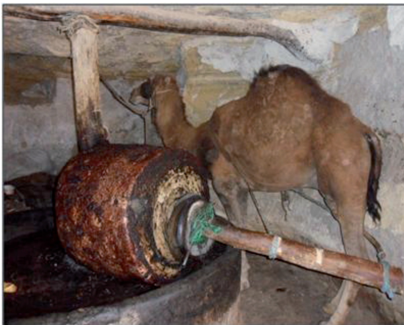
Figure 4. Photo d'une huilerie traditionnelle à traction animale (Nos photos, 2014)
